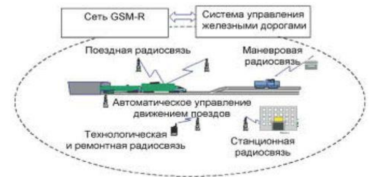
Рис. 1. Система связи GSM-R на железных дорогах
